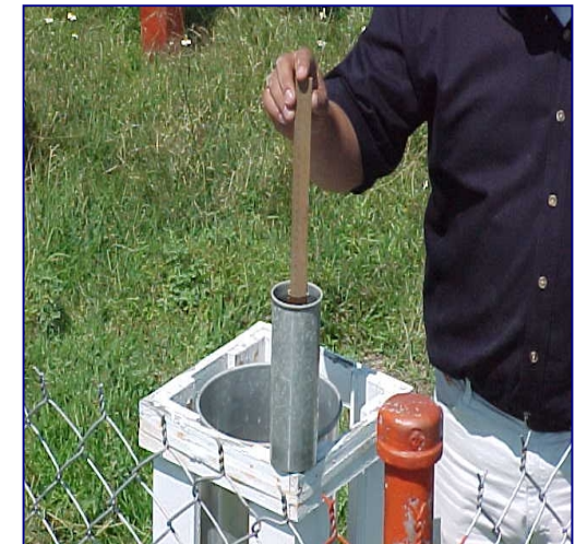
Uso de la regla de madera para medir la altura de agua dentro del vaso medidor.
